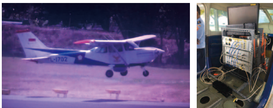
図1.1.1.2.-3. CバンドCP-SAR搭載セスナの飛行実証実験とRFシステム
