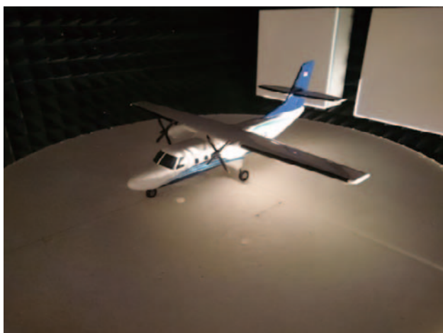
図1.1.1.1.-11. 直線偏波と円偏波の散乱特性確認：N219航空機の電波無響室内の散乱測定
