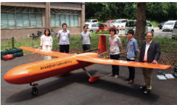
図1.1.1.1-5. CP-SAR 搭載用 UAV JX-2
