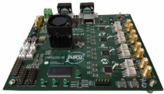
(D) 千葉大学発チャープ発生器 (8チャンネル出力)
