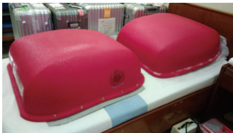
図1.1.1.2.-4. 新素材によるレドームの開発と実証実験
