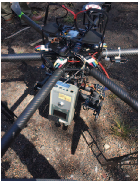
図1.1.3.1-3. 多方向スペクトル観測を行った際の放射計（MS-720）搭載のドローン（左図）と 45^\circ 観測地の飛行経路
