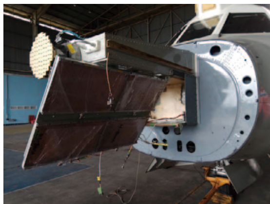
図1.1.1.1.-9. CP-SARの送受信用のマイクロストリップアンテナとCN235航空機に搭載した様子
