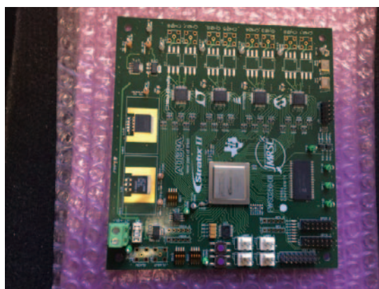
(D) 千葉大学発チャープ発生器（8チャンネル出力）
