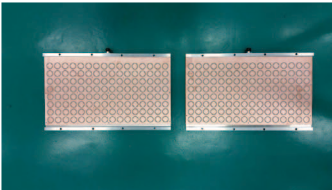
図1.1.1.1-11. CP-SARの送受信用のマイクロストリップアンテナと測定用の電波無響室
