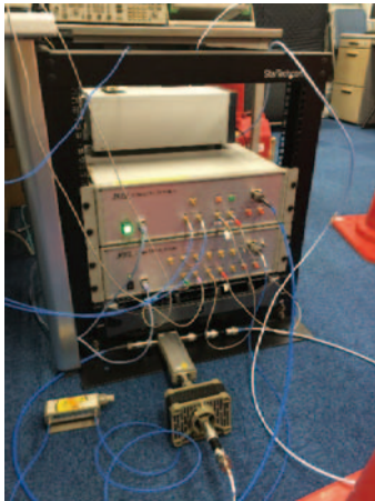
図1.1.1.1-6. CバンドCP-SARのシステム図
