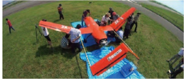
図1.1.1.1-2 合成開口レーダ搭載無人航空機 (JX-1)
