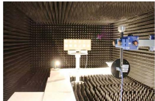
図 1.1.1.1.-11 CP-SARの送受信用のマイクロストリップアンテナと測定用の電波無響室
