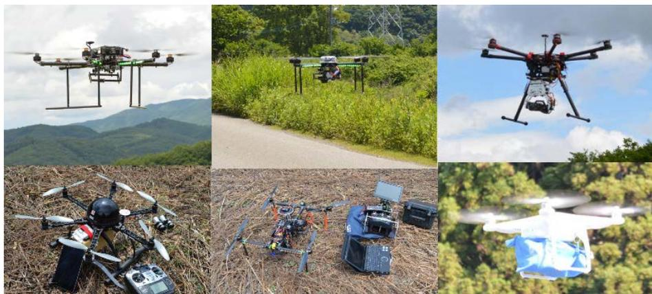
図 1.3.1.7 運用中の電動ラジコンマルチコプター。測量（オルソ空中写真の計測）、放射線計測、外来種モニタリング、作物生育モニタリング、熱赤外観測、等にUAVを活用した。
