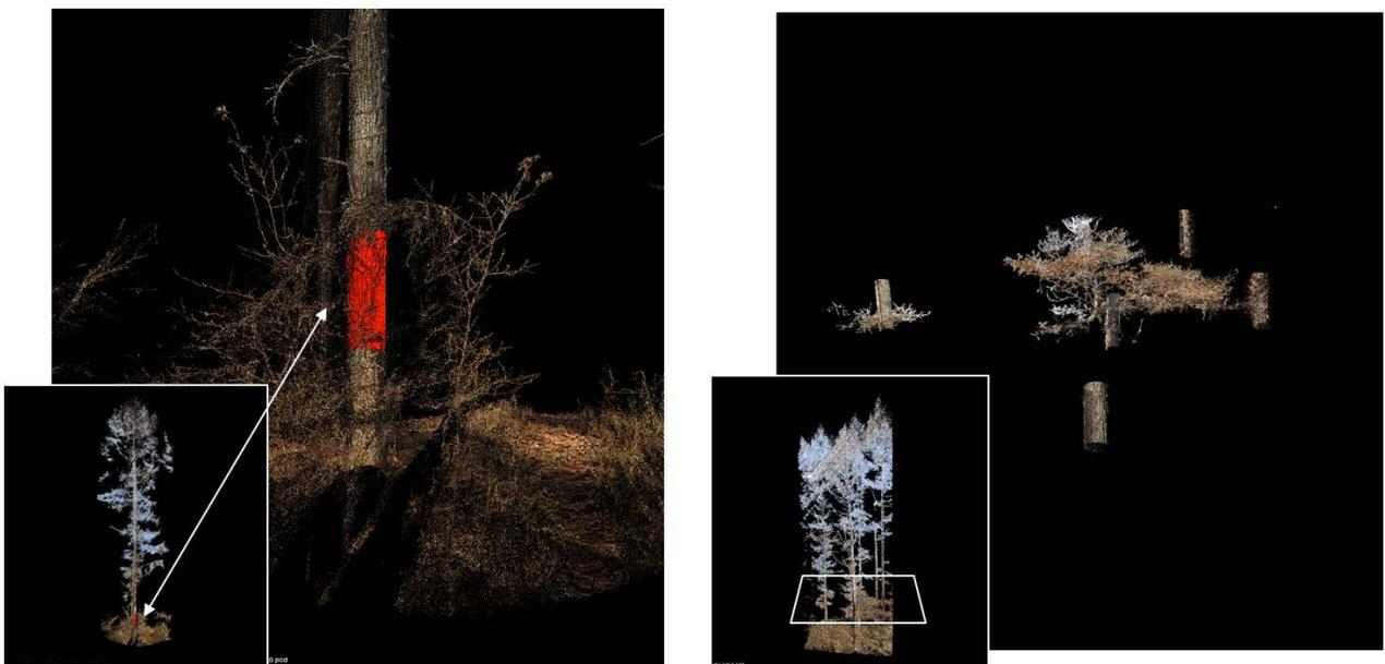
図 1.1.3.-3 点群データからの胸高直径推定（点群データはVZ-400（RIEGL）で取得したもの）
