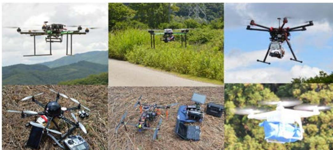
図 運用中の電動ラジコンマルチコプター。測量（オルソ空中写真の計測）、放射線計測、外来種モニタリング、作物生育モニタリング、熱赤外観測、等にUAVを活用した。
