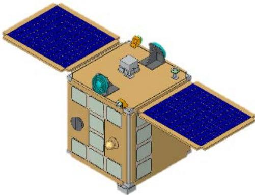
図 1.1.1.3.-1 電離層観測用小型衛星 GAIA-I
