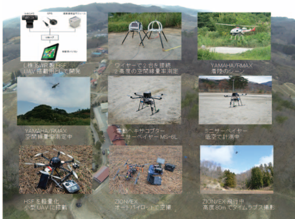
図 1.3.2. 小型 UAV 群による空間線量率計測、オルソフォト作成の様子
