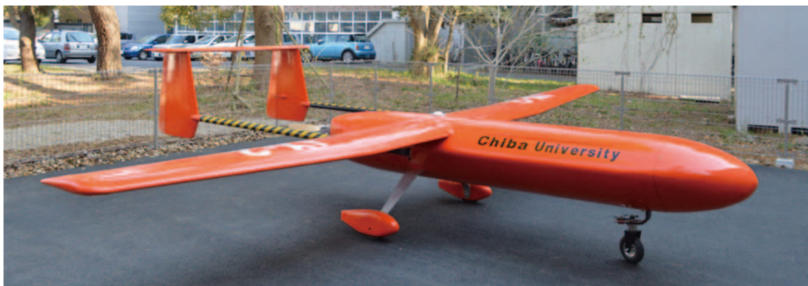
図 1.1.1.-5. CP-SAR 搭載用 UAV JX-2
