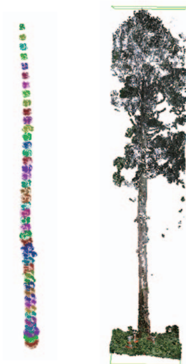
図 2. 樹木幹部の自動抽出にした結果（右図が単木単位での地上レーザーデータ、左図が自動で判別した幹部）
