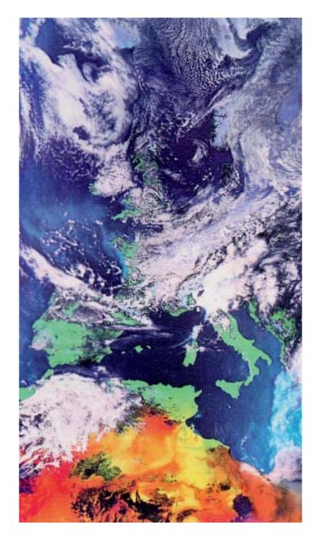
NOAA衛星に搭載されている AVHRRセンサーは約3000kmの刈 り幅で地表を観測する(左)
