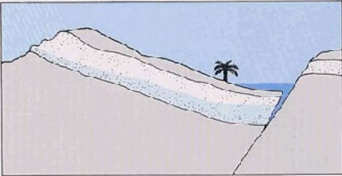
ふつう、オアシスの水の供給源は山脈（上左）の風上側に降る雨で、これが帯水層と呼ばれる多孔質の岩（点々の部分）にしみこむ。この地下水が帯水層の傾斜に沿って流れ、断層の部分（右）で岩に行く手を阻まれると、水圧によって地表に押し上げられてくる。
