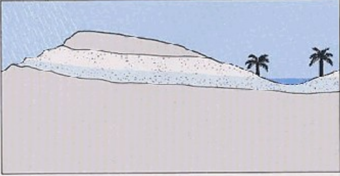
デフレーションと呼ばれる風と砂による侵食のため、地下水面よりも低い窪地（右）がつけられた場合にも、オアシスができる。帯水層の飽和している部分（青い部分）の水は傾斜にしたがって流れ、砂漠の表面が低くなった部分で地表に現れる。
