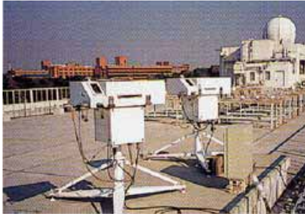
ブルーワ分光光度計を用いた 波長別紫外域日射観測(つくば)
