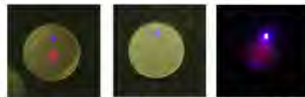
図12. Phantom 4で撮影したクロロフィルa (25 mg L -1 ) の蛍光イメージ。 左) ISO200, FG1枚 (%), 中) ISO 200, フロストガラス3枚 (%), 右) ISO 1600 フロストガラス5枚 (%) (イメージのため斜めからレーザー照射)
