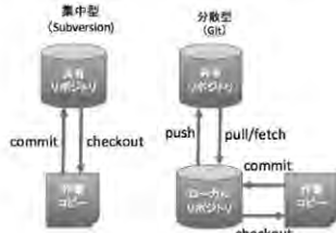
図1 バージョン管理システムの構造と操作
