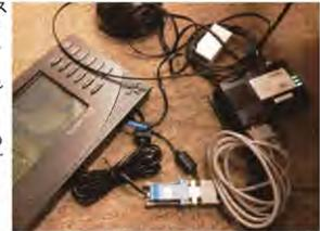
FOMAモジュール (右のランプの点灯している機器、上の白い直方体はアンテナ) 及び気象観測ステーションコンソール (左) がRS-232Cで接続される。
