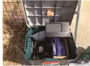
気象観測データの送信に関わる機器の設置状況 (青色:カーバッテリー 黒画面:気象観測ステーションコンソール 黄色シール貼付したものは:FOMAモジュール コンセントを持つものは:AC-DCコンバータ)
