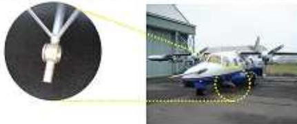
雲粒子によるレーザー光線の前方向散乱を利用して、雲水量と有効半径を測定する
