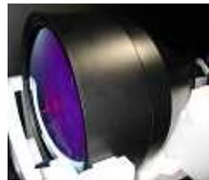
大口径イメージング intensified PMT
