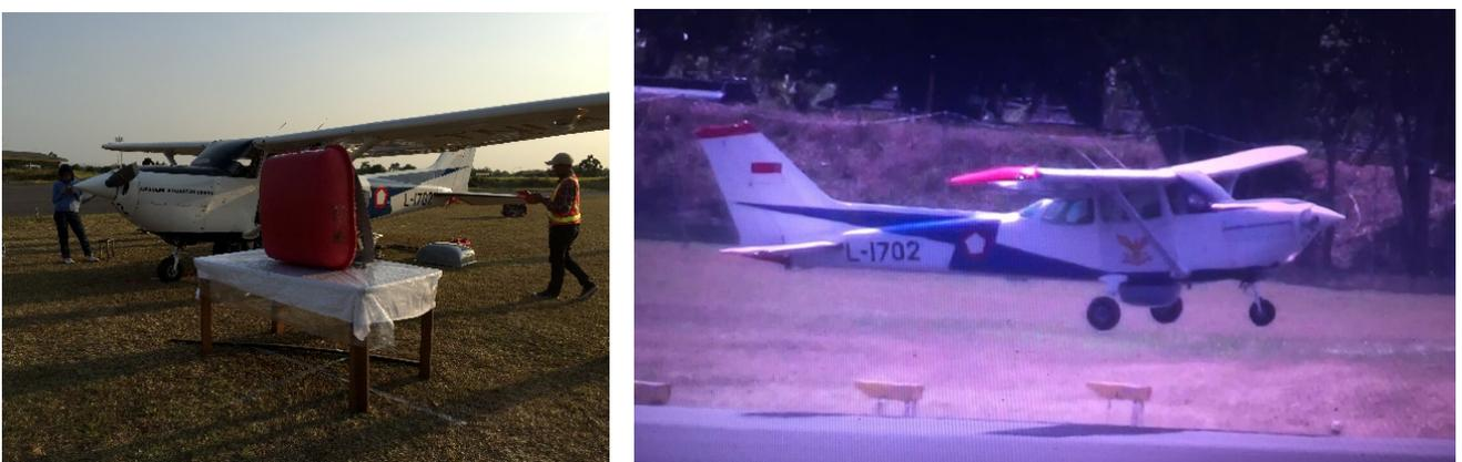
図 4. レドームとアンテナのポイントターゲット実験と飛行実証実験
