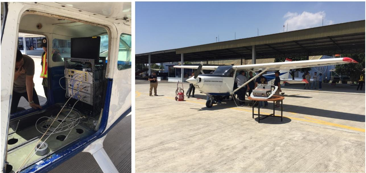
図 3. C バンド CP-SAR システムとパッチアレー・レドームの地上実験
