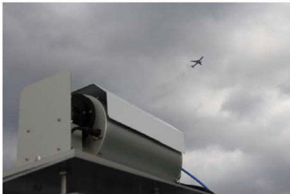
九州大学応用力学研究所に新設した MAX-DOAS 装置とその設置作業の様子。
