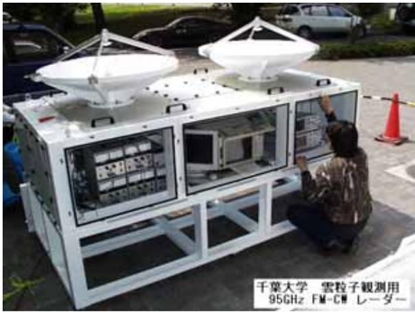
図1. 開発したミリ波 FM-CW 雲レーダの1号機、愛称 FALCON-1。直径1mのアンテナ2基からなり、左側が送信アンテナ(波長3ミリ波)で、直上の雲による反射波を右側のアンテナで受信する。
