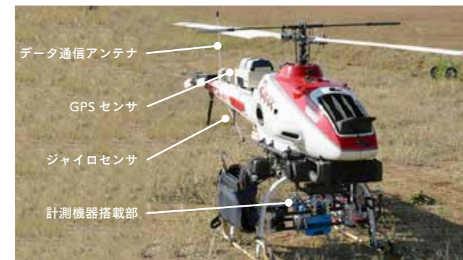
自律飛行ヘリコプタ観測システムの外観(腹部にレーザープロファイラ、デジタルカメラなど搭載) Radio Control Helicopter Observation system
