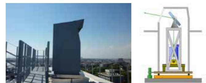
エアロゾルの水平分布を観測するための紫外ライダー装置 Plan position indicator lidar instrument for observing horizontal distribution of aerosol particles
