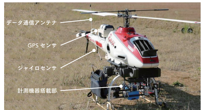
自律飛行ヘリコプタ観測システムの外観 (腹部にレーザープロファイラ、デジカメ、スペクトロメータなど搭載) Radio Control Helicopter Observation system
