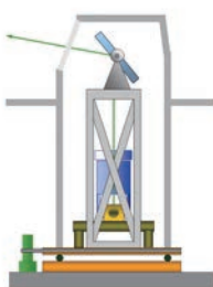
エアロゾルの水平分布を観測するための紫外ライダー装置 Plan position indicator lidar instrument for observing horizontal distribution of aerosol particles
