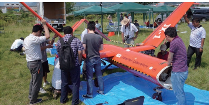
富士川滑空場にて合成開口レーダ搭載無人航空機の実証実験 Flight test of synthetic aperture radar onboard unmanned aerial vehicle at Fujikawa airfield
